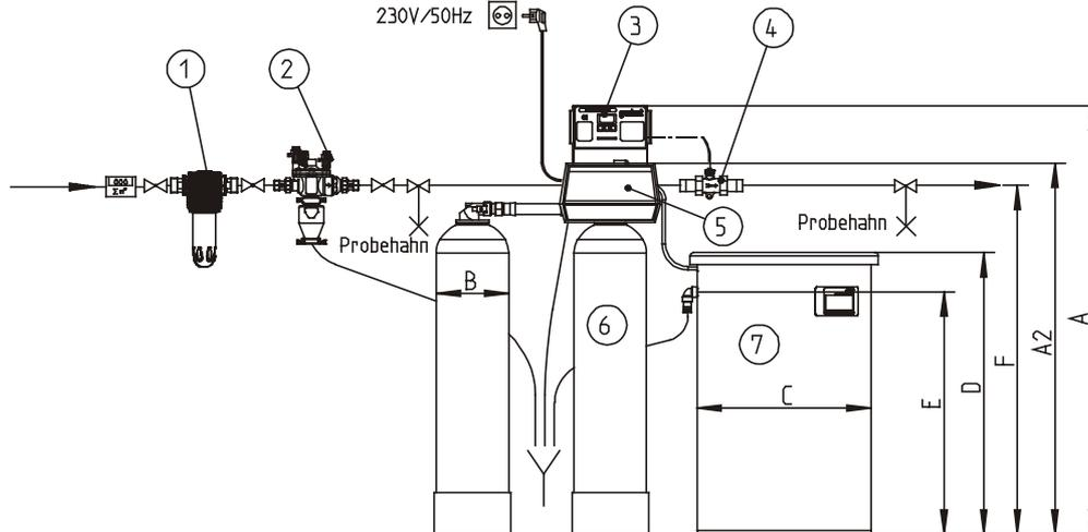
Abb. 2: Aufstellungszeichnung Enthärtungsanlage GENO-mat® duo WE
